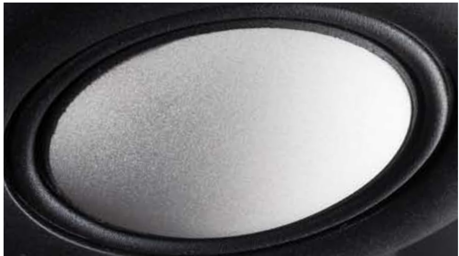
GANZ NAH: Die hauchdünne und federleichte Membran aus Diamant schimmert silbrig, weil sie mit einer Platinschicht überzogen ist. Ungewöhnlich für einen Hochtöner ist die recht große Sicke, die mehr Hub erlaubt, als herkömmliche Kalotten überhaupt klirrfrei vollführen könnten.
